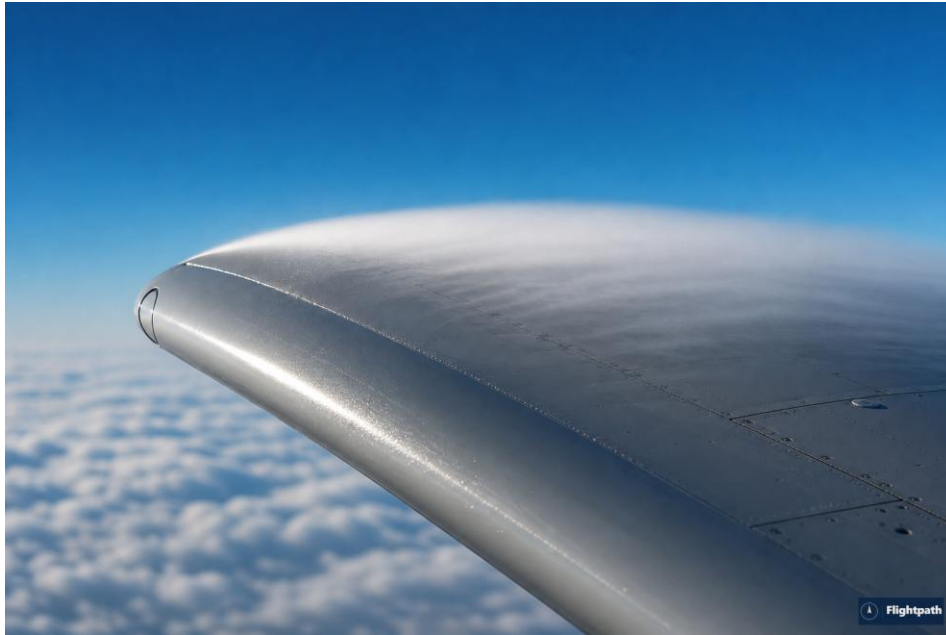
La sustentación se genera por la diferencia de presión entre extradós e intradós del perfil alar.
