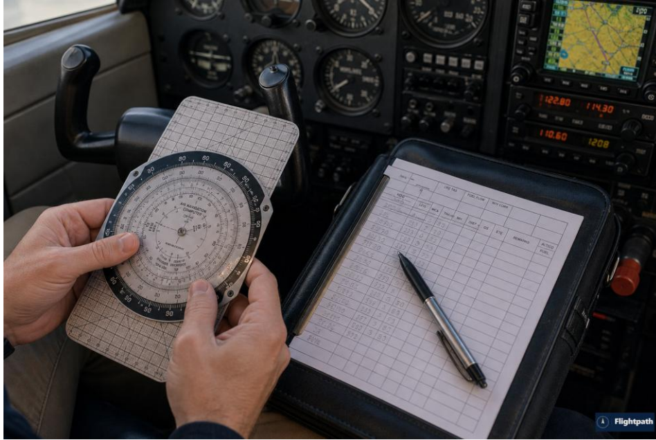
La computadora de vuelo E6B permite calcular vientos, correcciones y tiempos con precisión.
