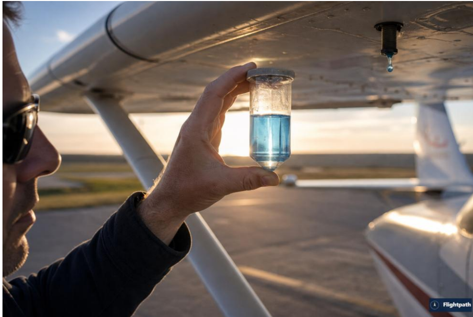
La verificación visual del combustible antes de volar detecta contaminación por agua u otros contaminantes.
