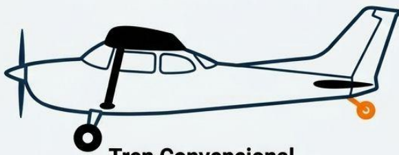
Tren Convencional (Aerodinámico, pero inestable en rodaje)
