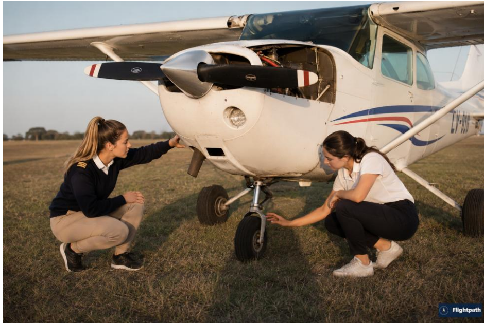
La inspección pre-vuelo del tren de aterrizaje es parte indispensable del walkaround sistemático.
