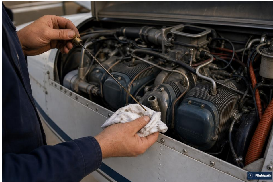
El mantenimiento y control del nivel de aceite del motor son críticos para la fiabilidad del vuelo.
